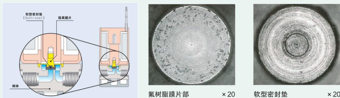
使用氟树脂的隔膜阀，发生最多的故障是异物或流体结晶粒等混入，损伤密封部发生泄露。我司使用具有优异耐化学性、特殊弹性体的全氟橡胶(FFKM)安装于密封部，配备能最大抑制损伤发生的备选零件软型密封垫。FFKM的耐化学性可与氟树脂匹敌，在分析相关和半导体相关的化学品的使用上，已获得国际高度评价。密封材质除FFKM外，也可选氟橡胶(FKM)。
