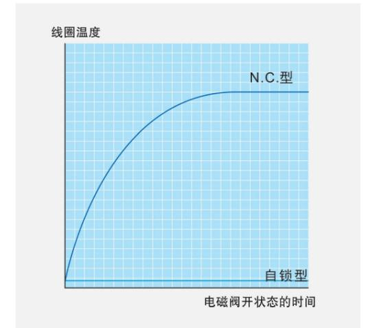
例如N.C.（通电时开）型的电磁阀为保持打开状态需要连续供电。而自锁型电磁阀在保持状态方面利用永磁铁的磁力，除了切换动作之外无需供电。最适合应用于需降低耗电及抑制线圈发热的应用。
