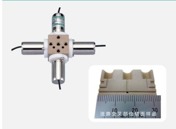
照片中的4元溶剂混合阀流路的合流部对加工精度的要求高，包括其他公司在内一般的溶剂混合阀基本上都是采用切削加工，成本很高。我司采用先进的技术，在合流部分实现PEEK成型加工，提供了溶剂混合阀前所未有的低价格。
