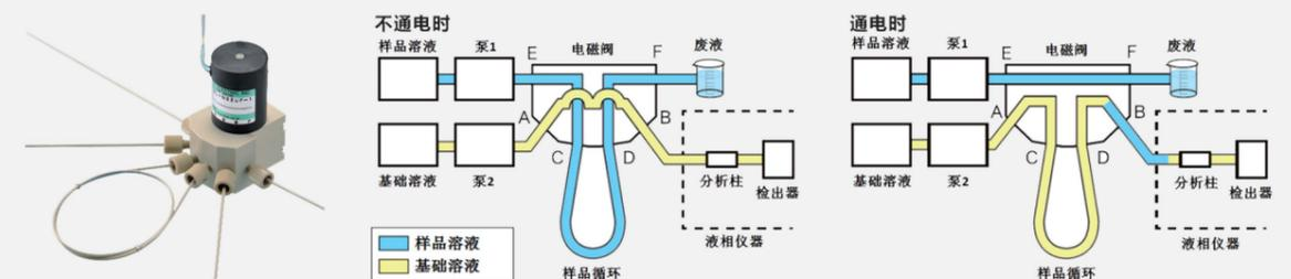
应用了滑板阀的分注阀。因为采用电磁驱动，无需步进电机和驱动。与以往的旋转式分注阀相比，操作简便、经济实惠。最适用于液相色谱等样品计量、分注等。
