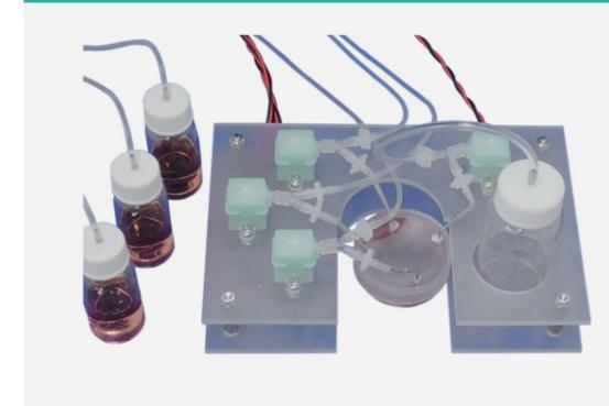
可以通过电脑编程轻松地更换用于分化培养的多种培养基和注入试剂。只需按下开始按钮，就可以自动完成培养基和试剂的注入和排出。即使培养基交换和试剂注入的时间偶尔在休息日和夜间也可以放心。比手工操作的再现性更高。由一个控制器和最多8个泵装有瓶子的冷藏箱组成。由此可实现最多7种培养基和试剂的自动化注入。泵单元可以与培养皿一起存放在培养箱中。通过定制，还可以实现转染的自动化。
