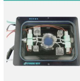
这是一个全自动化的系统，用于活细胞成像所需的培养基和试剂的移液操作。可以定量注射药物以观察细胞反应，也可以灌注培养基。泵单元为ANSI/SBS标准的孔板尺寸，可存储在STAGE培养箱中。使用高性能的小型泵，取代手动移液操作，使研究人员能够集中精力在显微镜下进行观察。
