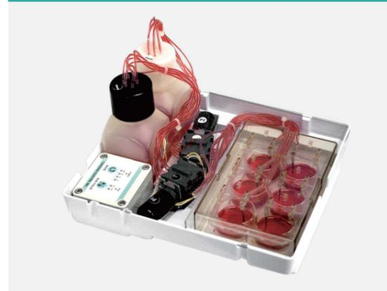
通过移液操作，将培养基的吸入和注入自动化的产品。
