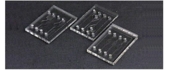
提供微流路芯片试作服务（名称：Chip Mart）。一枚也可以试做。材质为PMMA（聚甲基丙烯酸甲酯）、PC（聚碳酸酯）、PDMS（聚二甲基硅氧烷）等。也可提供由小型阀、微型泵、微小流量计等组合的流体系统。
