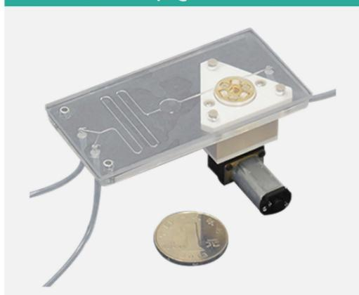
与蠕动泵原理相同，在芯片内部进行 $\mu$ L/min级别的微小流量送液(液体输送情况可扫描下方二维码通过视频观看)。具有自吸功能，可将外部流体导入芯片内部。只需将PDMS芯片与专用电机组紧密接触即可工作，可随流体更换芯片，以便一次性使用。关于流路，只需将与电机接触部分设计为指定形状，前后的流路可自由设计。也可提供几乎没有脉动的低脉动型。芯片设计相关请咨询。
