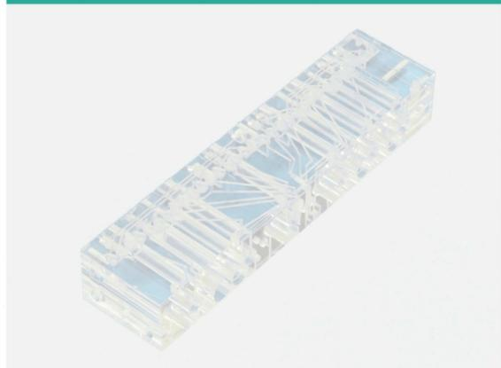
通过对表面加工有沟槽的树脂层进行贴合，在内部形成流路的多歧管基板。内部流路可自由弯曲，实现单纯的开孔加工无法做到的流路结构，使得集成度大幅上升。除PMMA外，也可加工耐腐蚀性优越的ALL PTFE多歧管基板。其他材质请咨询。
