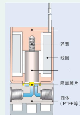
电磁阀可分为开闭流路的阀部分，以及使其动作的驱动部分。隔膜阀内部设有隔离上述两部分的膜片，可以防止流经氟树脂等制成的阀体部分的流体，流入主要由金属制成的驱动部分。这样可防止驱动部分被流体腐蚀，同时也能防止驱动部分产生的金属粉末等混入流体。这种构造最适用于介意杂质的分析仪器的进样部分和医疗仪器，以及易腐蚀金属的酸、化学品的处理。这种构造的阀也被称为耐腐蚀阀。
